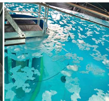
Skum med organisk materiale og suspendert stoff, observert under rengjøring av kar med Moleaers nanobubble-teknologi.
